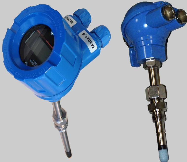
Les HRG40 sont des thermo-hygromètres de gainé d'air, de conception robuste, ils sont adaptés à un usage en milieu difficile. Le concept de mesure entièrement numérique (capteur inclus) leur assurent une très bonne répétabilité ainsi qu'une excellente tenue des caractéristiques à long terme.
